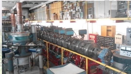
Инжектор ионов И-3, 4 МВ
