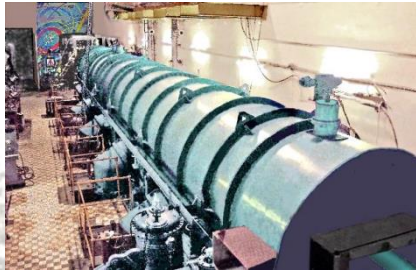
Протонный инжектор И-2, 25 MeV
