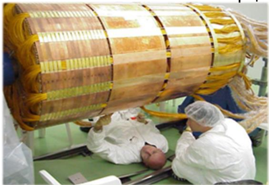
Передний калориметр ATLAS перед установкой в криостат
