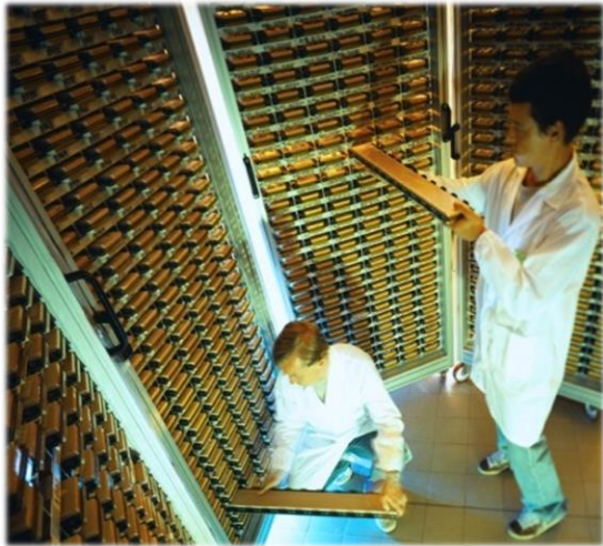
Сборка детекторов для системы TOF, сборка одного из 18 супермодулей TOF
