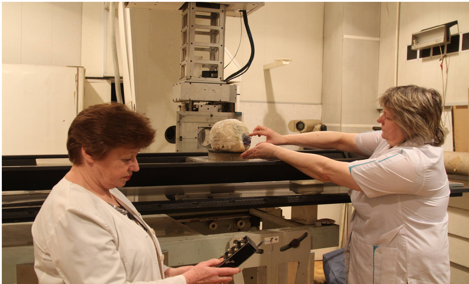
Моделирование Системы рентгеновского позиционирования. Установка фантома черепа на позиционере
