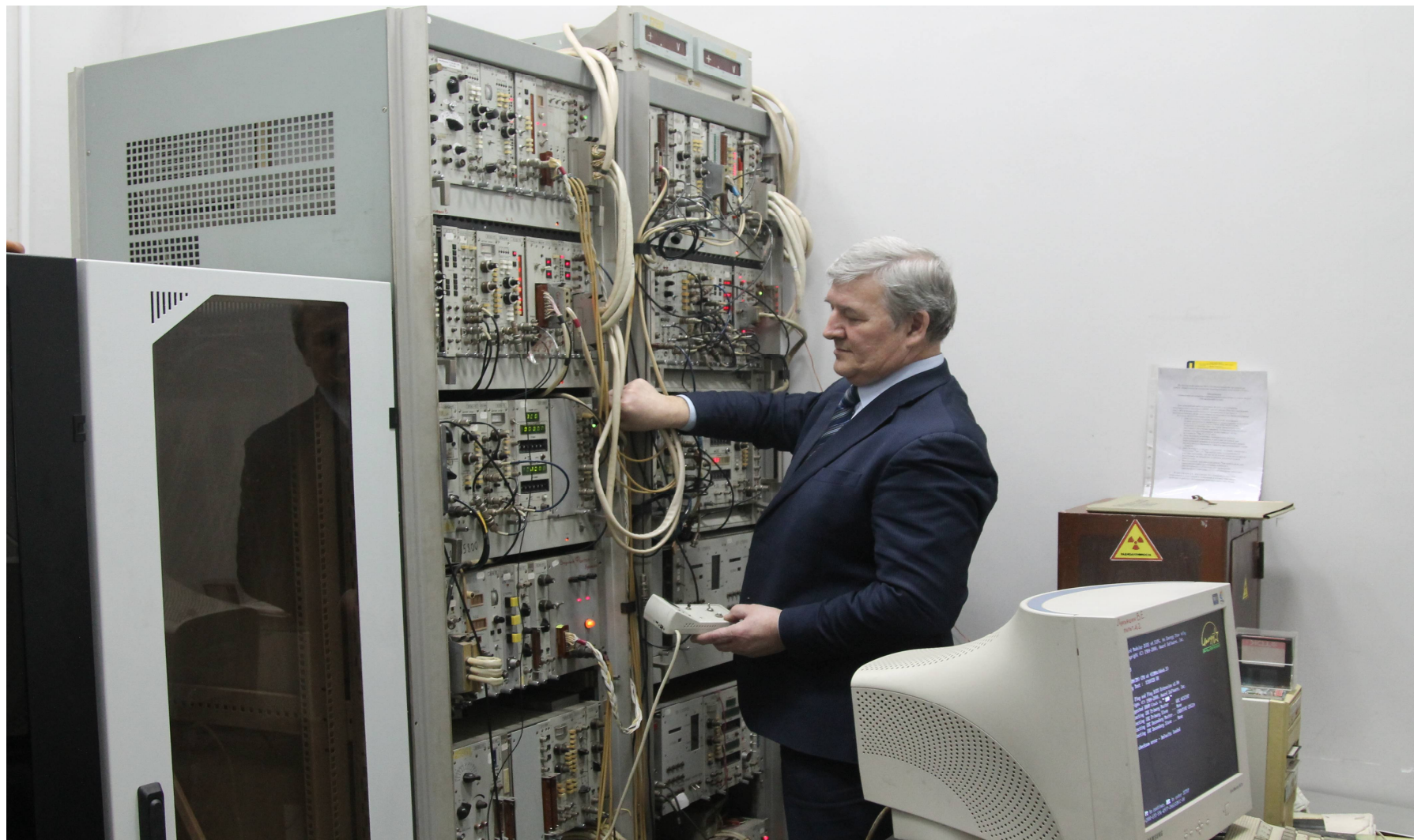
Наладка стоек электроники АСУ и локальной вычислительной сети
