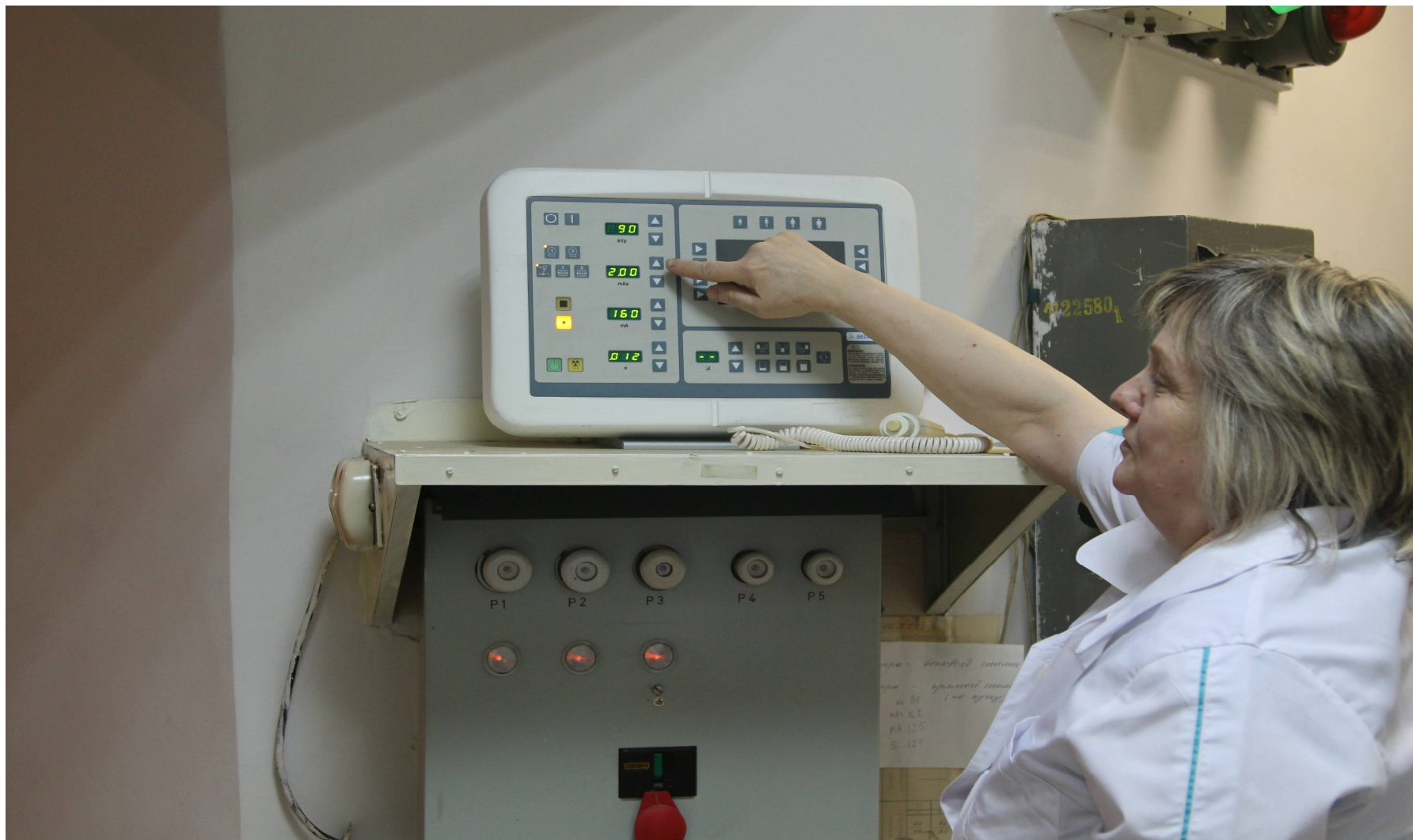
Моделирование Системы рентгеновского позиционирования. Установка режимов рентгеновского облучения фантома
