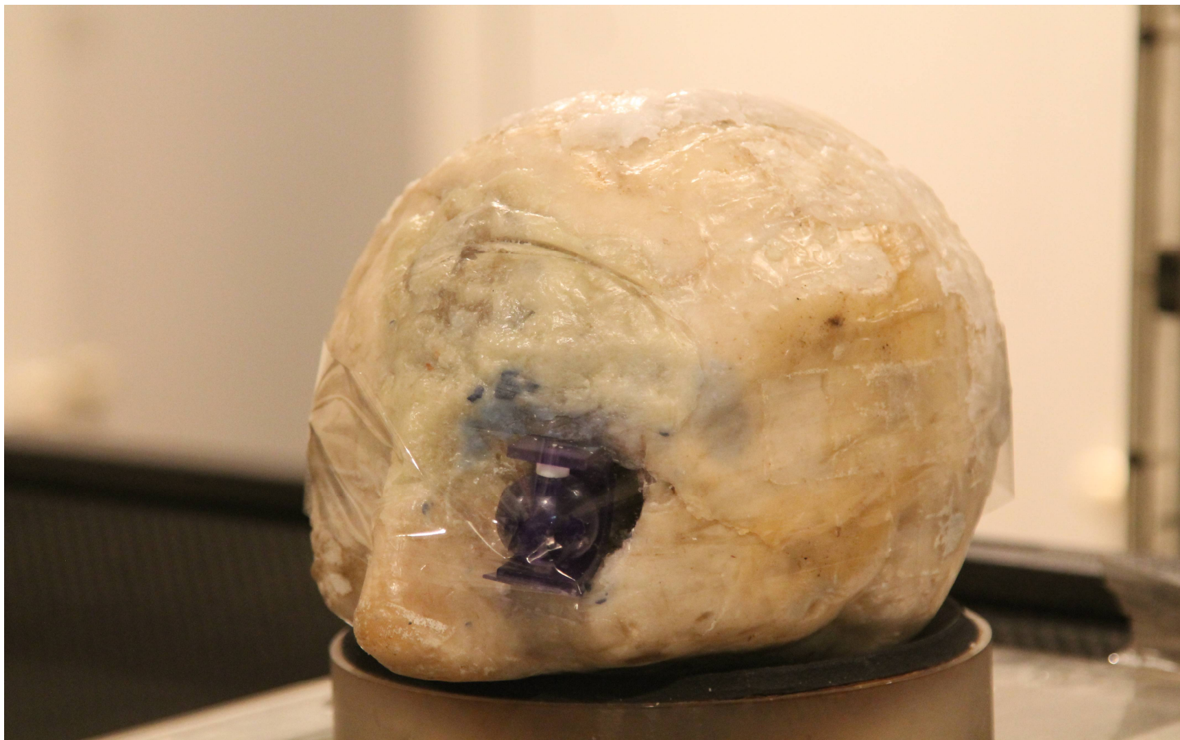
Моделирование Системы рентгеновского позиционирования. Фантом черепа с фантомом глаза
