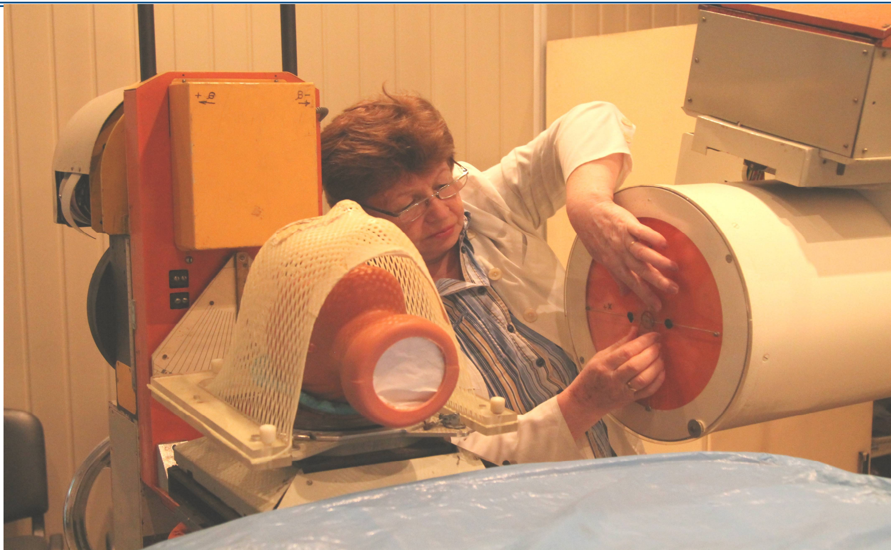
Моделирование Системы рентгеновского позиционирования. Установка масштабной сетки на электронно оптический преобразователь
