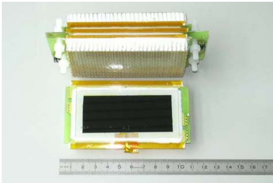
Рис. 5. Конструкция и фотография тестовой РППК.
