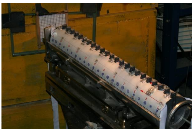
Рис. 1. Общий вид Pb- мишени вместе с экспериментальными образцами
